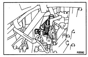
(d) Connect the two transaxle control cables to the transaxle.
