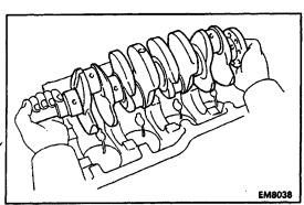
4. PLACE CRANKSHAFT ON CYLINDER BLOCK
