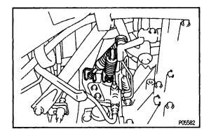
(d) Connect the two transaxle control cables to the transaxle.
