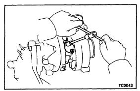
2. INSTALL SIDE BEARING HOUSING PLATE
