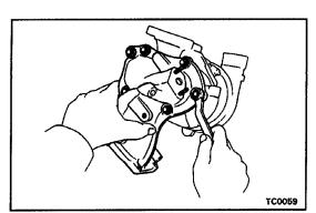
**30. REMOVE TURBING OUTLET ELBOW**
