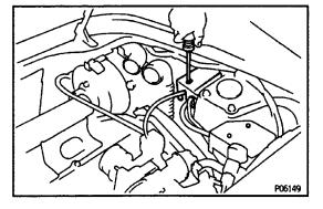
24. (w/ CRUISE CONTROL SYSTEM) INSTALL CRUISE CONTROL ACCELERATOR LINKAGE
