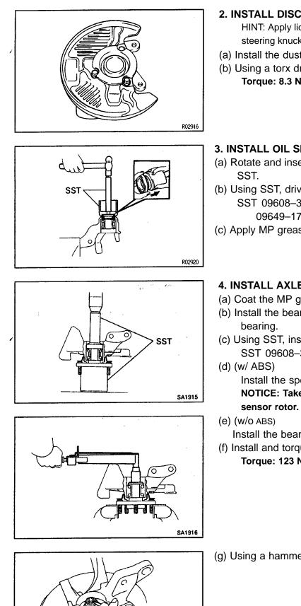
2. INSTALL DISC BRAKE DUST COVER
